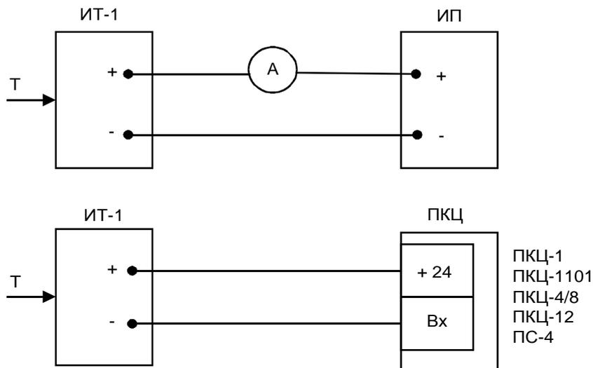
Рис. 4. Схемы внешних электрических соединений для размещения ИТ-1.хх во взрывобезопасной зоне
