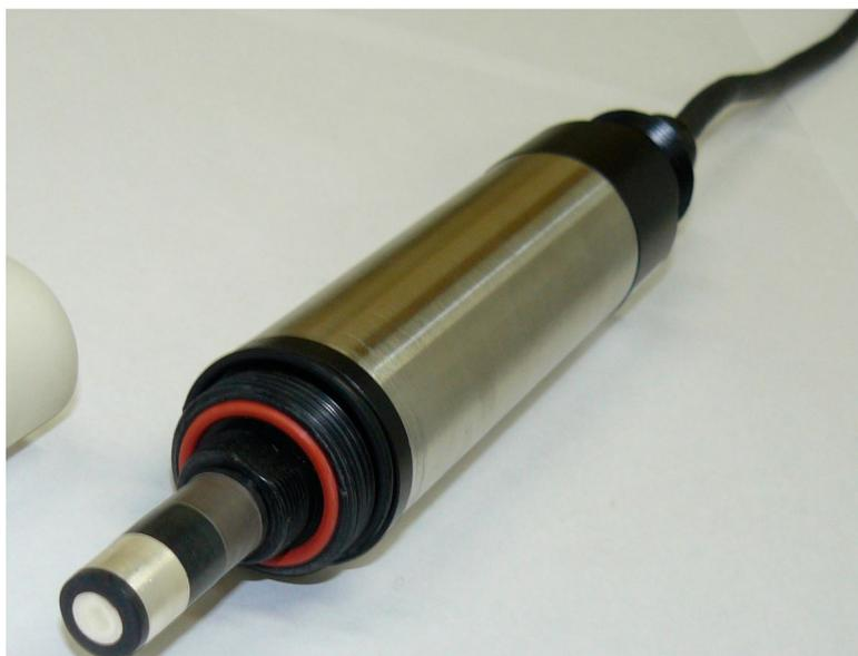
Рисунок 19 - Датчик кислорода со снятым мембранным картриджем
