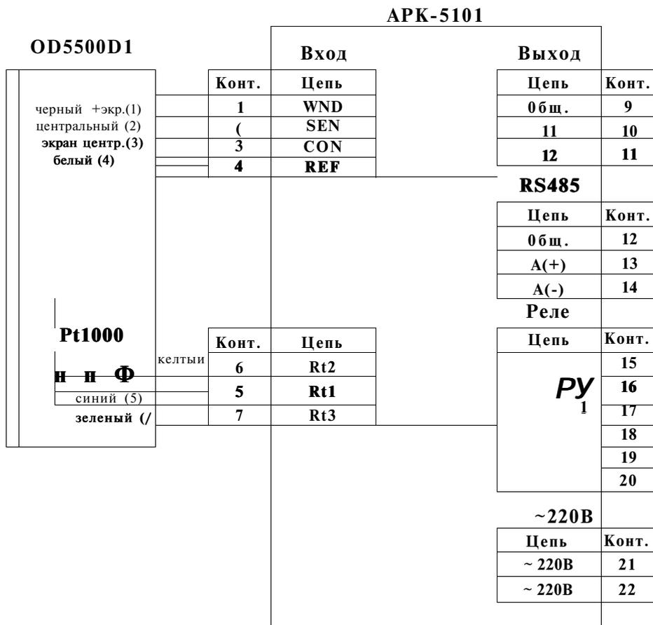
Схема соединений при проведении градуировки анализатора
