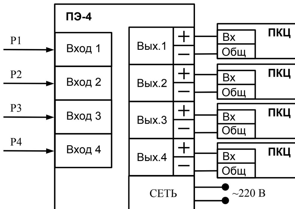
А – измерительный прибор; ПКЦ – прибор контроля цифровой серии ПКЦ
