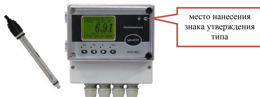
Рисунок 5 - рН-метр промышленный рН-4122, рН-4122.П (настенное исполнение), рН-4131
