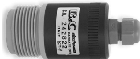
Датчик SI 3013 Корпус PP, электрод SS 316 K-1; T<50°C; Pmax=3 bar при 20°C; гермоввод; монтаж 1" BSP Датчик температуры RTD Pt100
