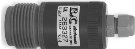
Датчик SI 301 Корпус PVC, электрод SS 316 K=1; T<40°C; Pmax=3 bar при 20°C; гермоввод; монтаж 1" BSP Датчик температуры RTD Pt100
