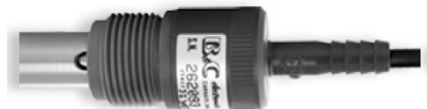
Датчик SZ308T. Для особо чистой воды Корпус SS316, PVC, электрод SS316 K=0,01; T<50°C; Pmax=3 bar при 20°C; кабель 3м;Монтаж: 1" BSP Датчик температуры RTD Pt100
